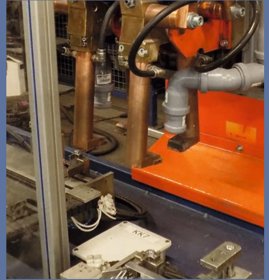
→ Extraction lors du soudage Robot de soudage avec sa propre aspiration, table aspirante pour le nettoyage du métal déployé
