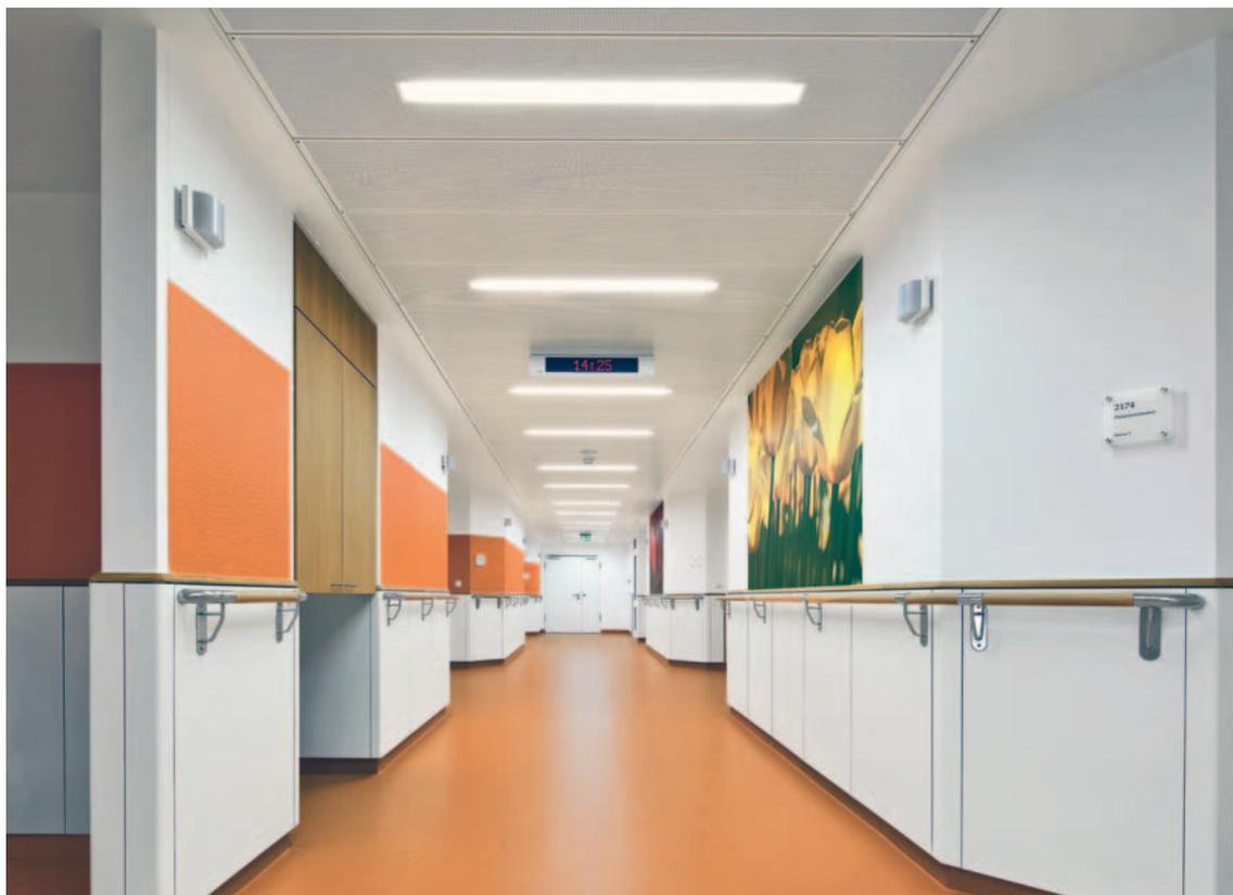
Als Maßnahme zur Strom-einsparung sind die neuen Deckenmodule mit integrierter LED-Beleuchtung eine interessante Alternative.
