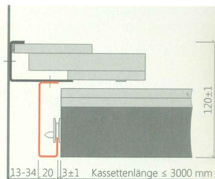
**500 Detailösungen.** Die neuen, flachen Gipskartonformteile (GKF) können durch einfaches Einschleiben von der Seite montiert werden, schwierige Verschraubungen an der Wand sind Vergangenheit. Die Montage wird so nicht nur einfacher, sondern auch um bis zu 30 % schneller.
