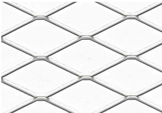
Masche 50 x 22 x 2,5 x 1,5 [mm] Mesh freier Querschnitt ca. 77,3% free cross-section approx.
